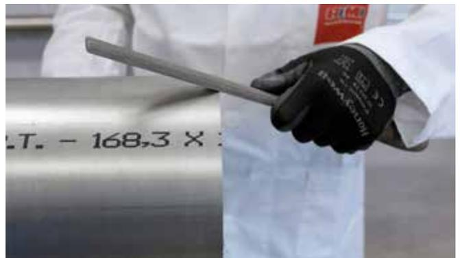
**Bild 13** - Entgraten des Leitungsrohres
