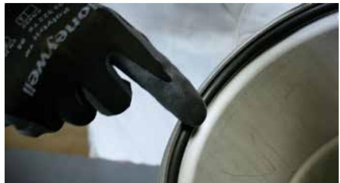
**Bild 16** - Überprüfung Dichtring
