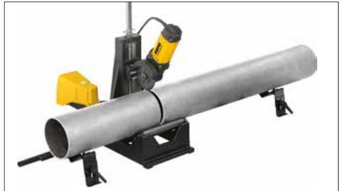
**Bild 12** - Ablängen des Leitungsrohres
